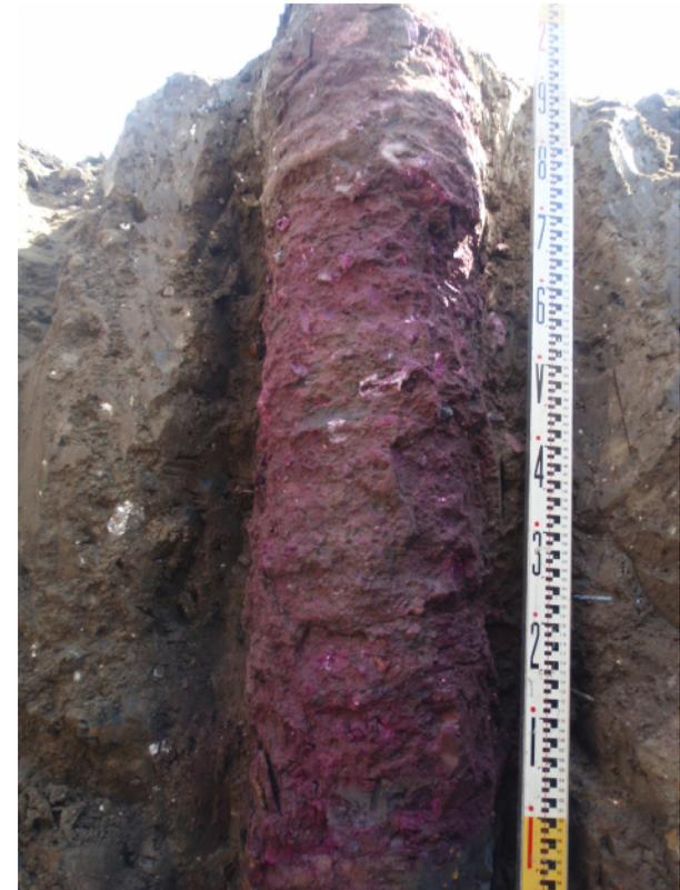
フェノールフタレイン溶液の吹付けにより補修地盤が杭先端まで築造されていることを確認しました。
