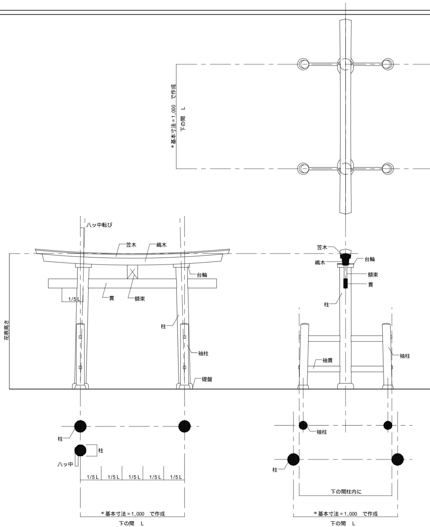
\* 基本寸法 = 1,000 で作成していますので、（移動 マウス倍率）で下の間 L を調整してください。
